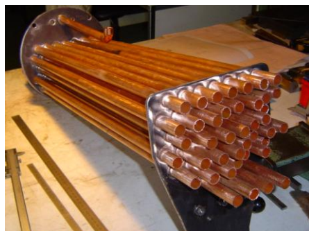
Tubes à fumée cuivre.
