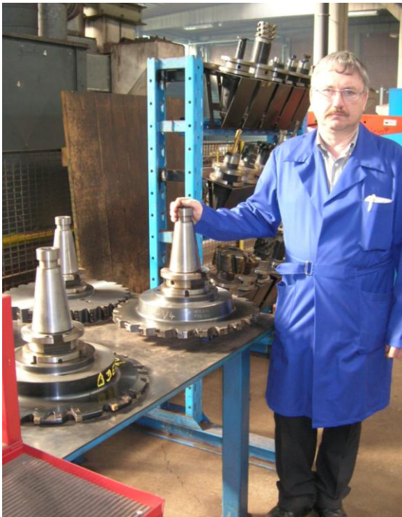
Les petites fraises utilisées pour les cœurs usinés dans la masse. Faut que ça morde !
