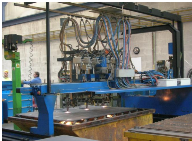
Découpeuse oxyacétylénique à 5 becs en action.
