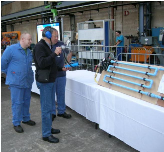
Recherche de fuites d'air à distance avec détecteur à ultrasons et pointeur laser.
