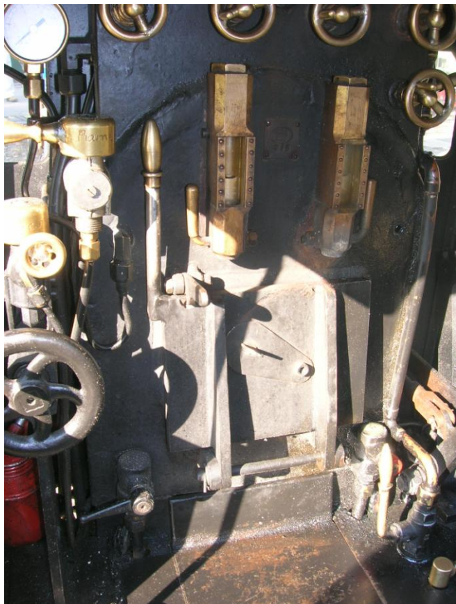
Ci-dessus, porte de foyer fermée, inclinée vers l'avant de la machine. Ci-dessous, porte ouverte. La flèche indique le loquet de sécurité. Dans le plancher de l'abri, une trappe permet le nettoyage facile du cendrier, sans contorsions autour ou sous la locomotive.
