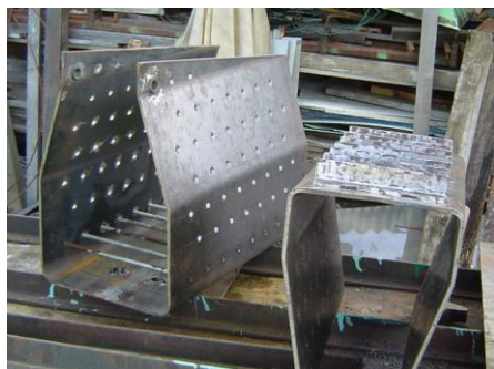
Eléments de boîte à feu.
