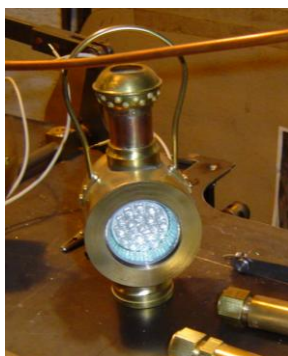
Lanterne équipée de diodes électroluminescentes (en anglais LED).
