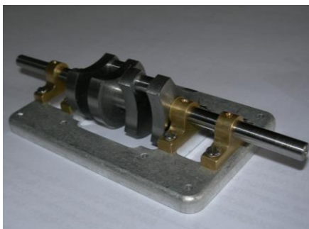
Montage du vilebrequin dans ses paliers.
