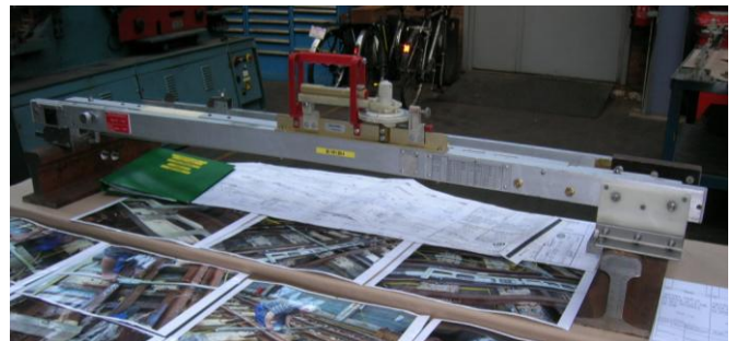
Règle de contrôle des voies fabriquée à Bascoup.
