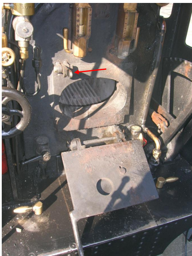
Ci-dessus, porte de foyer fermée, inclinée vers l'avant de la machine. Ci-dessous, porte ouverte. La flèche indique le loquet de sécurité. Dans le plancher de l'abri, une trappe permet le nettoyage facile du cendrier, sans contorsions autour ou sous la locomotive.
