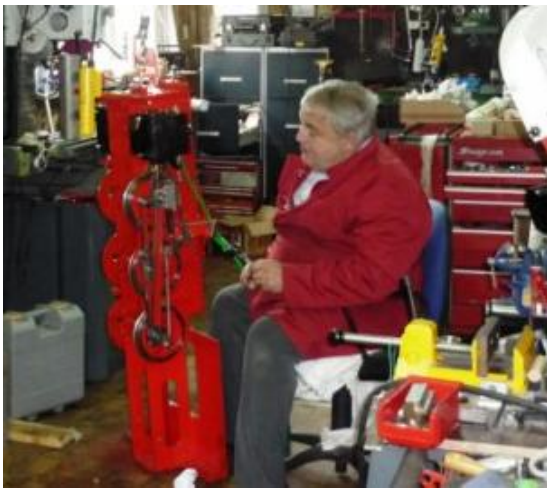
En Belgique, Aimé MICHAUX nous indique que la mécanique de sa 030 Du Croo & Brauns (programme Smars/Fécherolle) tourne grassement et comme une horloge sous 0,5 bar d'air comprimé. Il a constaté que la position verticale du châssis était très pratique pour de très nombreuses phases de la construction. Bonne continuation et au plaisir de voir cette 030 au PTVF.
