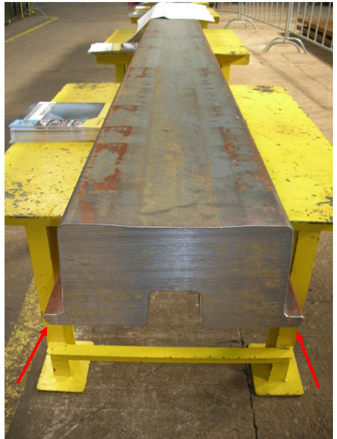
Avant fraisage..... Remarquez les pattes inférieures qui deviendront patins des rails.
