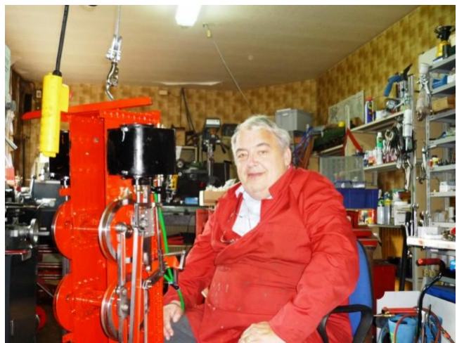
En Belgique, Aimé MICHAUX nous indique que la mécanique de sa 030 Du Croo & Brauns (programme Smars/Fécherolle) tourne grassement et comme une horloge sous 0,5 bar d'air comprimé. Il a constaté que la position verticale du châssis était très pratique pour de très nombreuses phases de la construction. Bonne continuation et au plaisir de voir cette 030 au PTVF.
