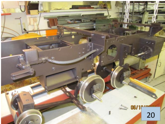
20 : Le maître cylindre est installé sur le longeron et le couvercle sera accessible depuis le plancher de cabine pour une mise à niveau éventuelle du liquide de frein commandant le frein à disque. La mise en place des essieux, du bissel, du cendrier, des moteurs et supports divers est maintenant définitive.
