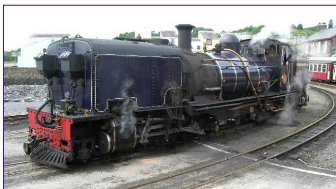
La 131+131 Beyer-Garrat NG/G16 n°87 : superbe ! Caisses à eau sur le premier truck moteur, soute à charbon sur le deuxième truck moteur.
