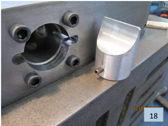
18 : Voici le déflecteur fait en AU4G dont la goupille évite à celui-ci de tourner dans l'échappement.
