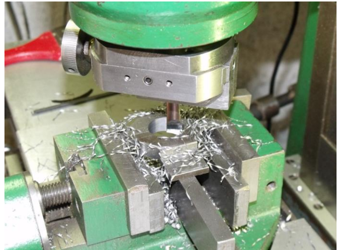
Quelques photos des différentes phases d'usinage des bielles suivant la variante de construction du plan 47 bis.
