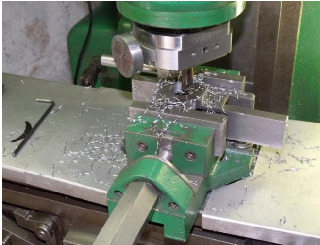
Quelques photos des différentes phases d'usinage des bielles suivant la variante de construction du plan 47 bis.
