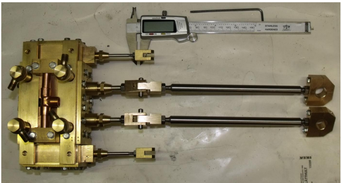
Bloc moteur équipé de ses bielles motrices. La partie supérieure du bloc moteur comporte les purgeurs de cylindres. Photos : J. Granet.
