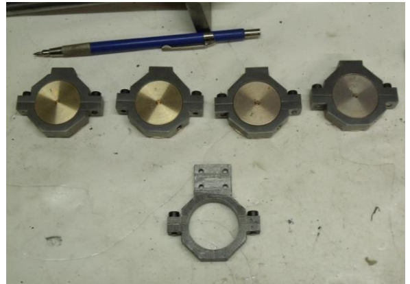
Quelques photos des différentes phases d'usinage des bielles suivant la variante de construction du plan 47 bis.
