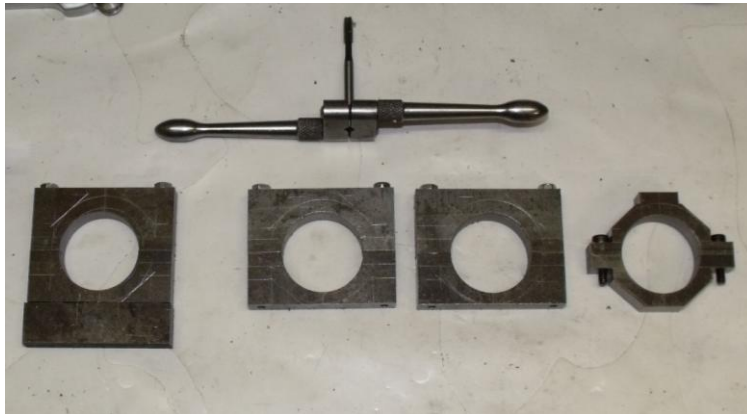
Quelques photos des différentes phases d'usinage des bielles suivant la variante de construction du plan 47 bis.
