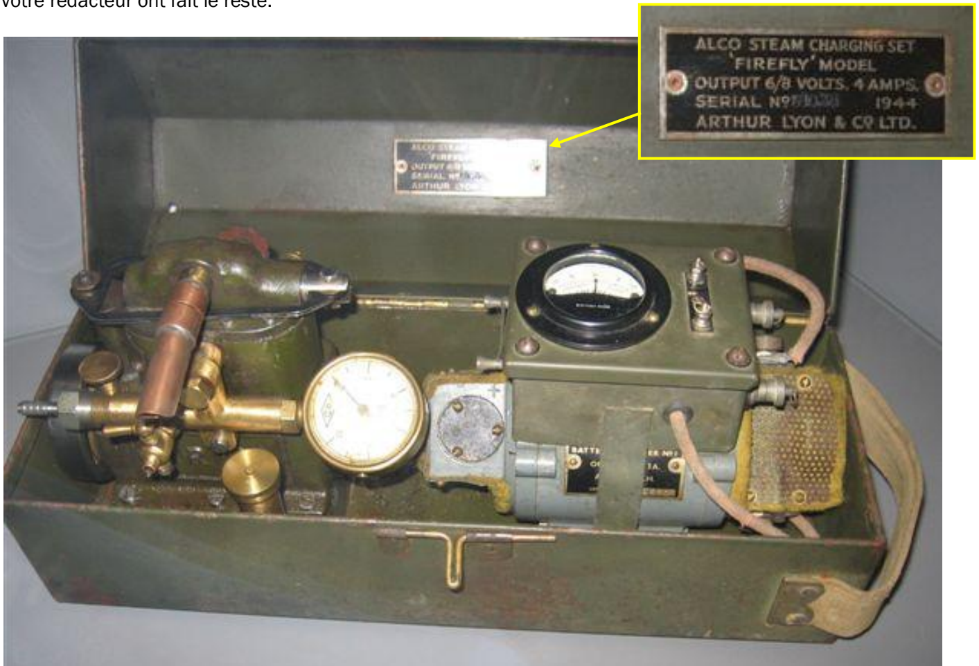
Le chargeur de batterie à vapeur tel que présenté dans une vitrine du musée.
