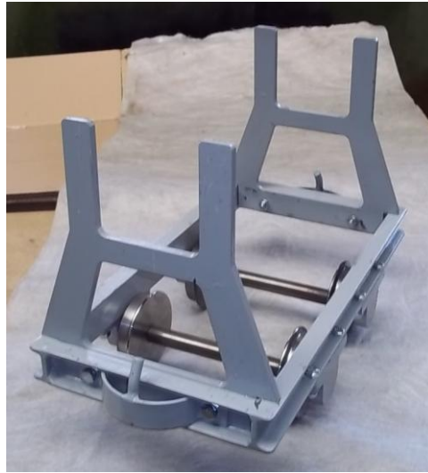
Montage des supports de benne et des extrémités (fixées par les mêmes boulons).
