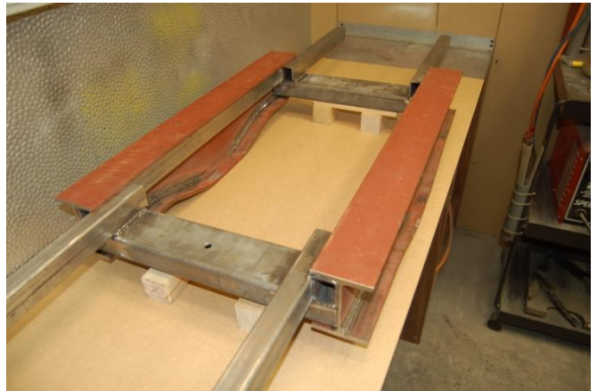
Montage du châssis : tubes rectangulaires et poutrelles.
