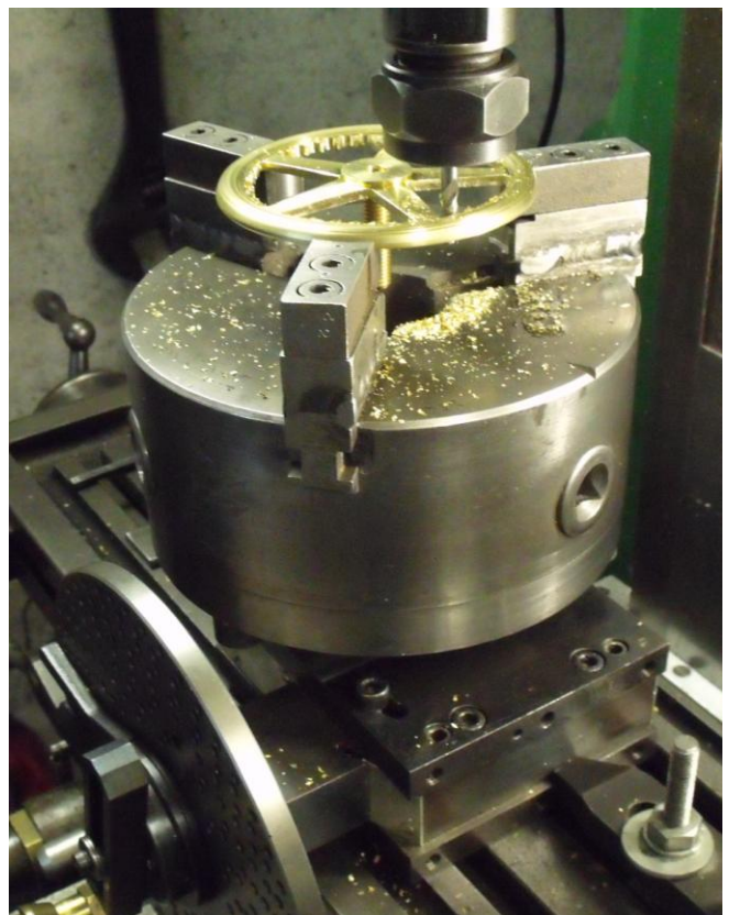
Fraisage du volant de direction (plan 32). Notez l'utilisation du plateau diviseur.
