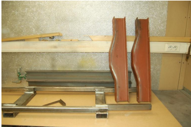
Montage du châssis : tubes rectangulaires et poutrelles.
