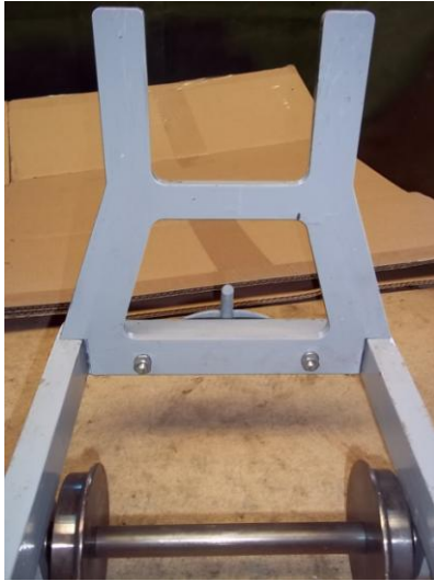
Montage des supports de benne et des extrémités (fixées par les mêmes boulons).
