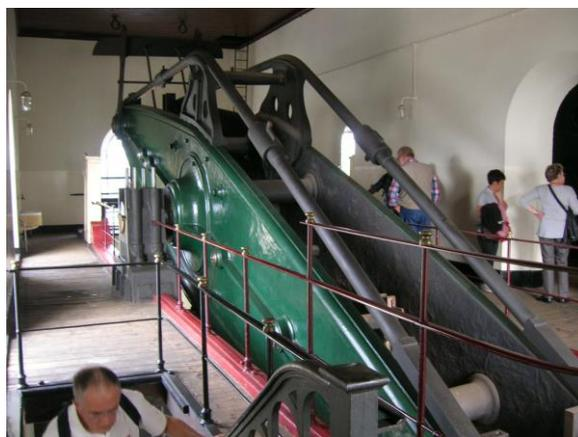
1<sup>er</sup> étage : cylindre moteur, presque 3m de diamètre ! 2<sup>ème</sup> étage : le lourd balancier forgé par Harvey & Co, Hayle Cornwall.
