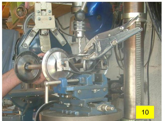
Photo 9 : les roulements sont mis en place légèrement en force.
