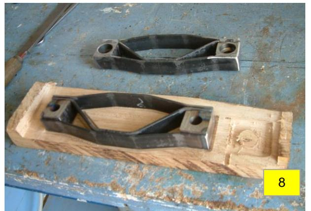
Photo 7 : pour assembler mes longerons de bogies, j'ai fait un outillage en bois, usiné à la fraiseuse CNC. Il me permet de garantir le même écartement entre les boîtes d'essieux.
