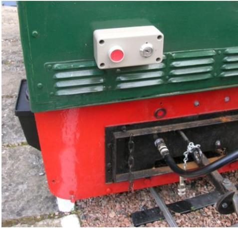
Les matériels moteurs et remorqués sont freinés au frein à vide. A l'arrière de la cabine fermée on peut remarquer un boîtier comportant une serrure de sécurité et un bouton poussoir rouge. En fait, ce bouton rouge permet au premier occupant du wagon de tête d'arrêter l'engin et de freiner en cas de nécessité lorsque la machine est mise entre les mains d'un conducteur novice en cours de formation à la conduite. Une idée à retenir...
