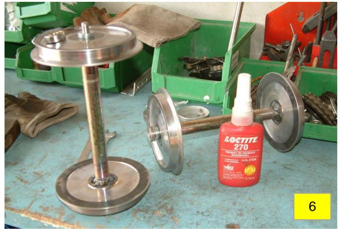
Photo 5 : assemblage des essieux du bogie AV. le tour me permet de faire les choses facilement et sans risque d'avoir une roue qui voile. L'axe est centré avec un comparateur (la photo a été prise trop tard, on ne le voit plus !). Les axes sont soudés au TIG sur les roues par 3 points de 1cm de long. Cela rend l'assemblage plus facilement démontable que si j'avais soudé sur tout le pourtour.
