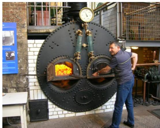
*Les moteurs géants des différentes sortes de pompes étaient alimentés en vapeur par des batteries de chaudières comme celle-ci, mais de dimensions doubles. Construites par Lancashire, à deux tubes foyers, elles étaient sous la responsabilité d'un chauffeur qui avait plusieurs chaudières à gérer simultanément. La présente chaudière alimentait en eau chaude les bains publics de la ville de Chiswick.*
