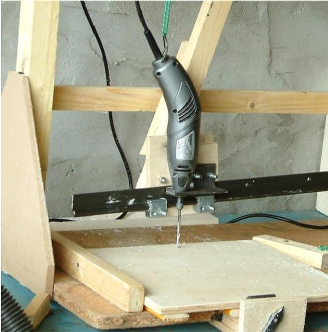
Pour reproduire la pièce, je fixe une mini perceuse équipée d'une fraise à bout sphérique de diamètre 4mm sur l'axe de reproduction du pantographe.
