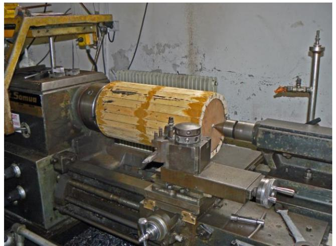
Usinage au tour de la chaudière. Mon tour étant largement trop petit en capacité de diamètre, j'ai donc utilisé celui du club CMCF. On voit ici la pièce bridée en contre-pointe prête pour l'usinage.
