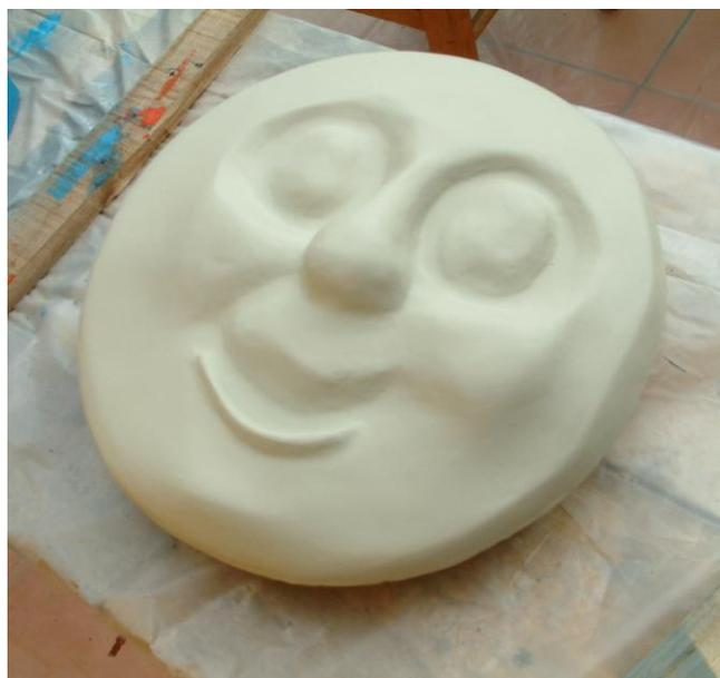
Trois couches d'une sous-couche spéciale pour carrosserie, avec léger ponçage entre chacune d'elles, me permettent d'enlever encore quelques défauts. Je termine par deux couches de la couleur de fond, et deux couches de noir pour le dessin des yeux et sourcils. Il ne reste plus qu'à coller le visage sur le devant de la chaudière.
