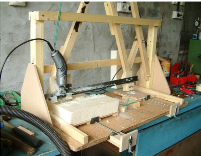
Avant de commencer, je dois placer (en jouant sur sa manivelle) le plateau supportant le modèle, de telle sorte que la pointe suiveuse du pantographe vienne affleurer le modèle lors de la première passe, et placer le plateau supportant le brut en polystyrène, de telle sorte que la fraise fasse sa première passe d'usinage au ras du bord de la matière.
