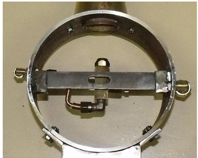
Les deux supports de verrouillage de porte de boîte à fumée ont été soudés à l'intérieur de celle-ci. L'ensemble échappement/souffleur a été monté. La barre transversale de verrouillage est placée ensuite dans ses encoches. Enfin, la porte de boîte à fumée ferme le tout.
