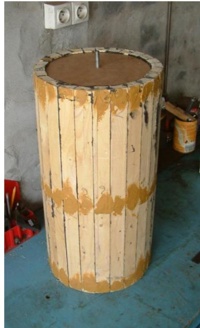
Le SIKA est sec. Pour augmenter la solidité de l'ensemble, j'ai vissé chaque latte sur le listel des fonds et sur le disque intermédiaire. Des avant-trous ont été percés dans les lattes pour recevoir et cacher les têtes de vis. J'ai ensuite rebouché les trous avec de la pâte à bois. Les vis doivent être enfoncées suffisamment pour ne pas réapparaître lors de l'usinage de la chaudière.
