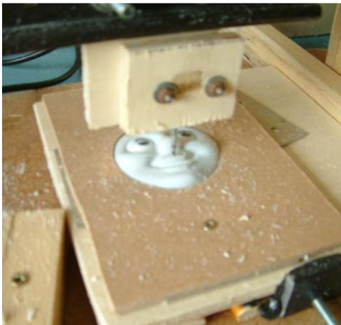
Je fixe sur le petit plateau le modèle à copier, et sur le grand plateau un morceau de polystyrène extrudé dans lequel je vais usiner la pièce finale. La machine est terminée. Il me faut maintenant faire l'usinage.
