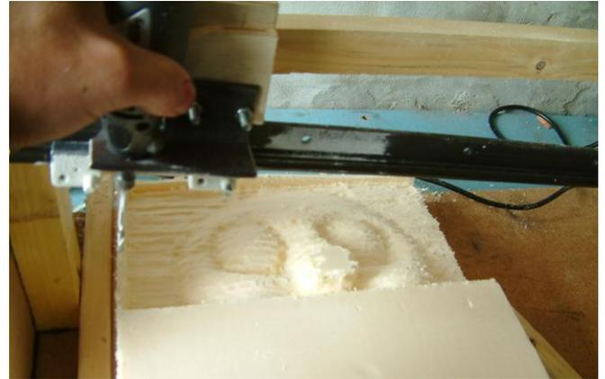
La méthode de travail consiste à faire l'usinage de la première passe en bougeant le pantographe (de gauche à droite et de bas en haut, ou l'inverse, axe X et Z), de façon à ce que la pointe suiveuse soit toujours en contact avec le modèle, ce qui permet à la fraise d'usiner le brut avec une proportion x 4.
