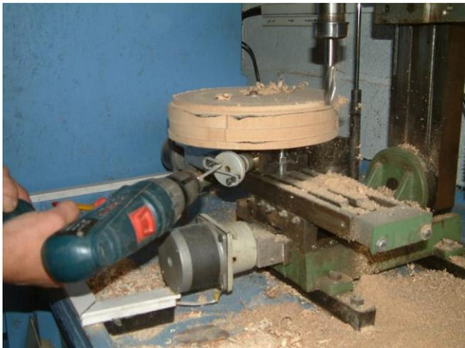
Usinage de la pièce. Comme le diamètre était trop important pour passer sur le tour, j'ai fait un petit montage sur la fraiseuse avec une table rotative sur laquelle j'ai fixé ma pièce. Amenée ensuite à la bonne position, je fais tourner la table (avec la perceuse pour aller plus vite) et je descends la fraise à chaque passe. On voit bien sur la photo suivante, la qualité de l'usinage.
