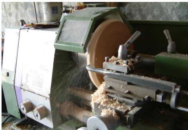
Après découpe à la scie sauteuse, usinage des fausses roues au tour CNC.
