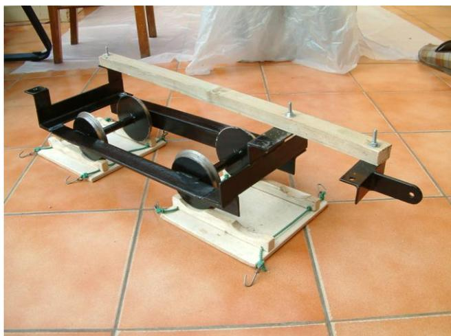
Les deux essieux porteurs de la locomotive sont terminés. Les pièces du train de roulement sont peintes en noir (2 couches). L'ensemble est prêt pour un essai de roulage avec le tender.
