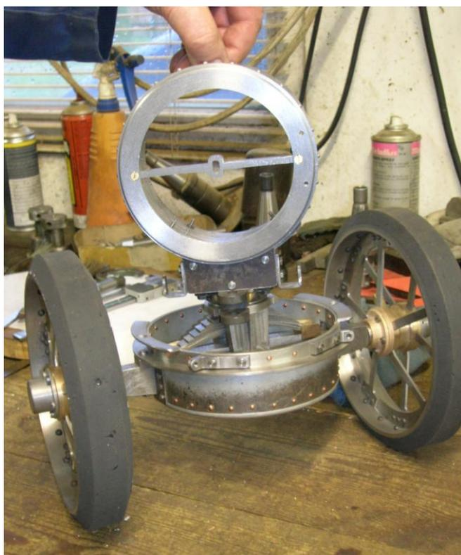
D'autres pièces annexes attendent leur montage : la cheminée, la selle de cheminée, la pompe à eau manuelle (dans le chariot du mécano), le cendrier. Ce cendrier présente une particularité intéressante ; la grille de foyer fait corps avec celui-ci tout en étant articulée. Lorsque l'on ouvre la trappe inférieure du cendrier pour nettoyage, la grille du foyer bascule, jetant ainsi le feu, ou ce qu'il en reste, et se présente facilement pour être déclassée.
