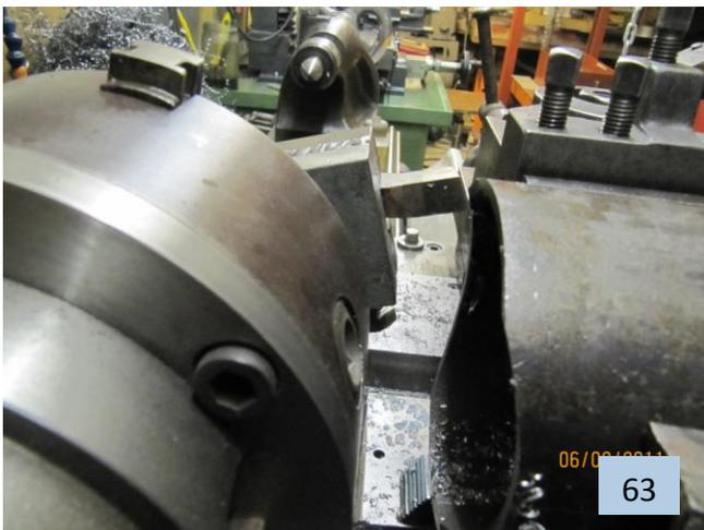
**63** : Dans le genre « *il n'y a pas de problèmes, que des solutions* », il a fallu modifier le tour pour usiner les dômes (faux dôme de vapeur et dôme de sablière). En effet, compte tenu de la dimension des pièces, l'outil a été positionné dans le mandrin et la pièce sur le porte outil. Ames sensibles s'abstenir car l'usinage tient plus de l'étau limeur que du tour. Mais ça marche très bien et le résultat est à la hauteur.
