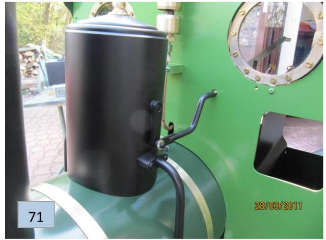
**71** : ... tel que la commande de la sablière et les tuyaux de descente du sable vers les roues.
