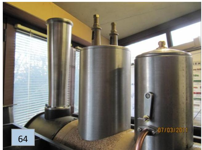
**64** : La fixation de ces faux dômes est effectuée par les pions filetés réservés dans la chaudière. L'alignement et les raccordements sont parfaits.
