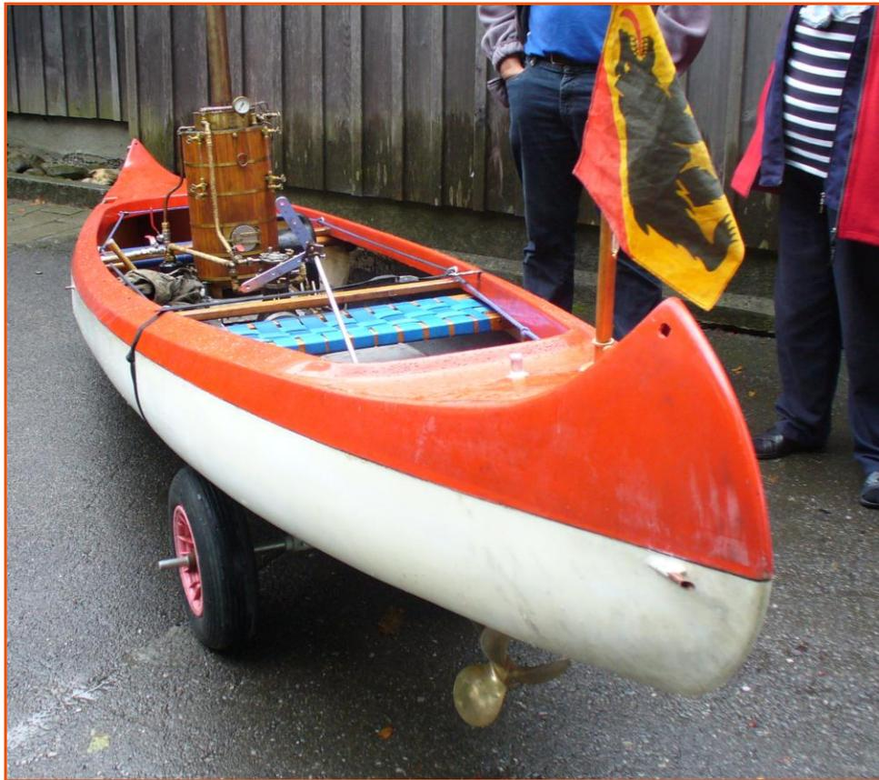
*Canoë vu par l'arrière. On distingue nettement l'hélice et le petit tuyau de sortie de vapeur d'échappement. Le gouvernail n'est pas encore en place. Grâce aux rampes d'accès aux plans d'eau, le canoë est mis à l'eau en marche arrière, équipé de ses deux roues porteuses. Dès sa flottaison, l'essieu roues porteuses est désolidarisé. Une simple sangle de maintient à desserrer. On ne peut plus simple !*
