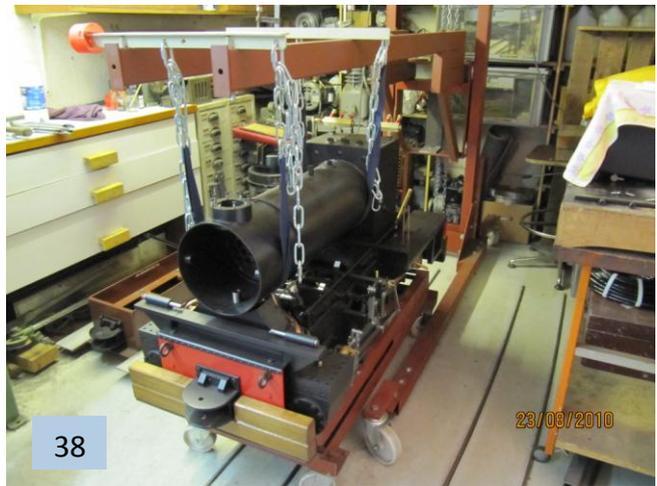
**38** : Toute la plomberie dans le châssis étant terminée, il faut maintenant remettre en place la chaudière qui a été peinte avec une peinture haute température. La grue est là encore d'une grande utilité pour se préserver les « côtelettes ».
