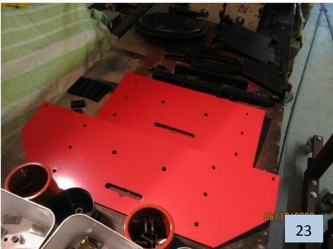
**23** : Pour terminer l'assemblage du châssis, les traverses avant et arrière sont peintes en rouge. (Laque automobile en bombe sur apprêt chromato-phosphatant)
