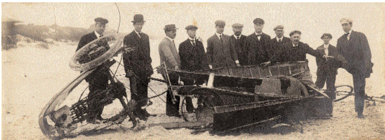
La « Rocket » après son accident. On reconnaît, à gauche, le moteur à deux cylindres monté horizontalement.
