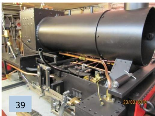
**39** : Toutes les commandes sont installées, relevage, freinage (sabots et disques).
