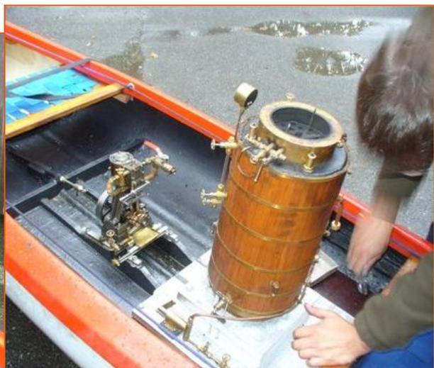
Ci-dessus, installation rapide de l'ensemble chaudière et moteur au fond du canoë. On notera le cordage violet de commande du gouvernail, manœuvrable depuis n'importe quel point de l'habitacle (flèche bleue). Assis, le « capitaine » a le moteur entre les mollets, et la chaudière est accessible en tendant les bras.
